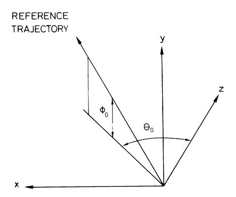
SPECIFICATION OF INITIAL ANGLES  $\theta_0$  AND  $\varphi_0$  FOR BEAM LINE LAYOUT.
